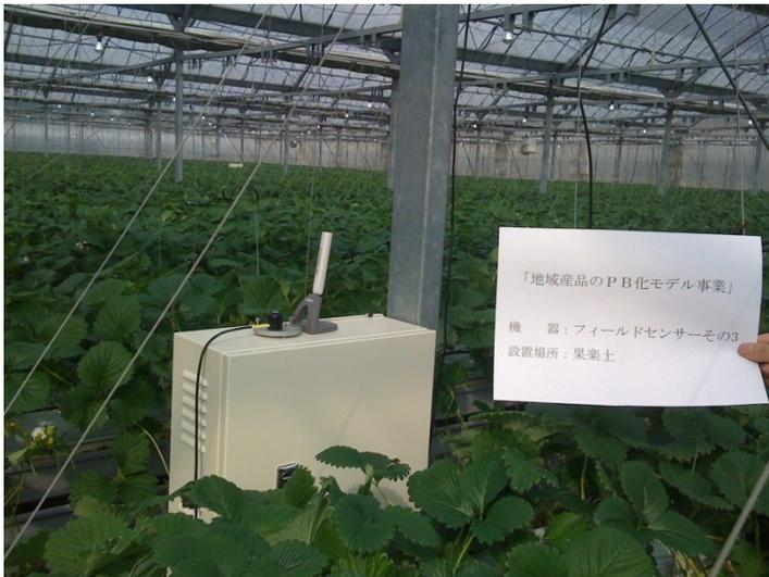
図3 フィールドセンサの設置状況(イチゴ農家)
